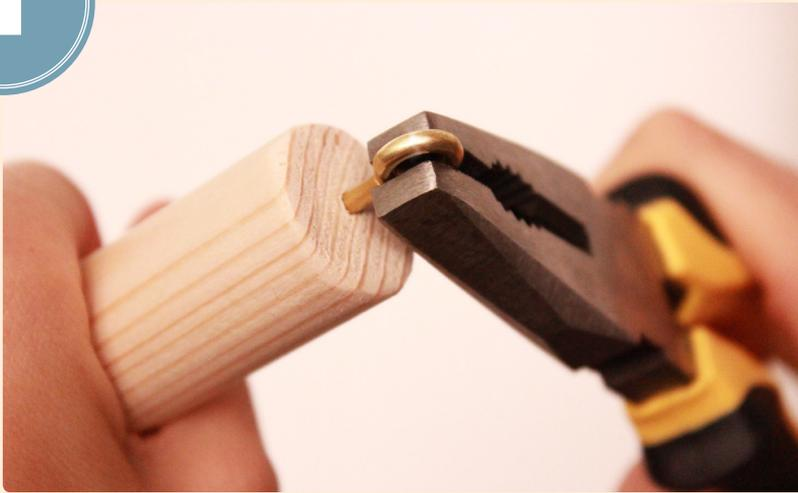
Zuerst schraubst du an beiden Enden je eine Ringschraube in den Stock. Nimm für die letzten Umdrehungen eine Zange, damit die zwei Schrauben gut festsitzen.
