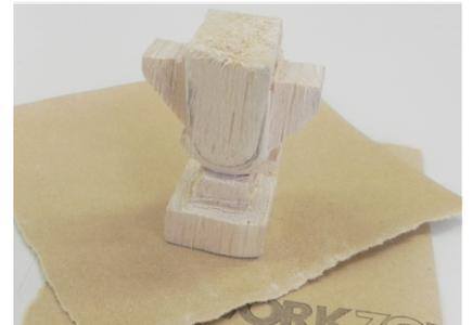
**3** Schnitze die Rundung jetzt etwas feiner, damit des Schleifen einfacher wird.
